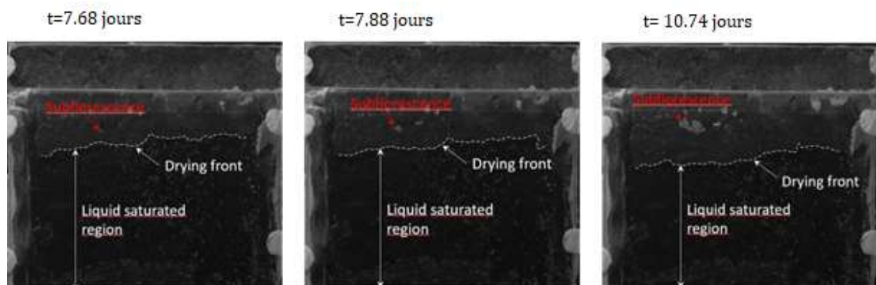
Figure 5- 6 : Croissance de la subflorescence de type 1 à une distance du front de séchage.
